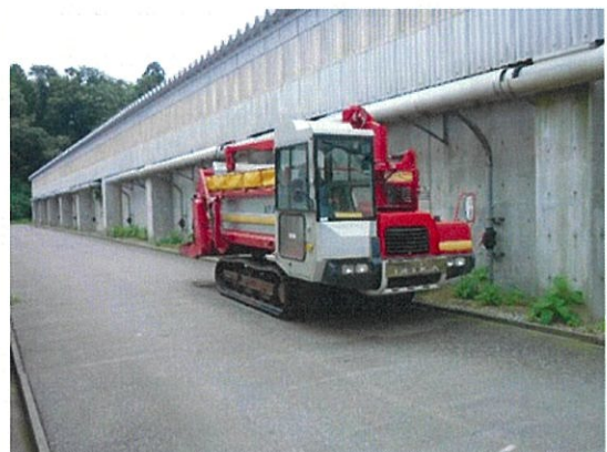
写真6 自走式堆肥散布車
