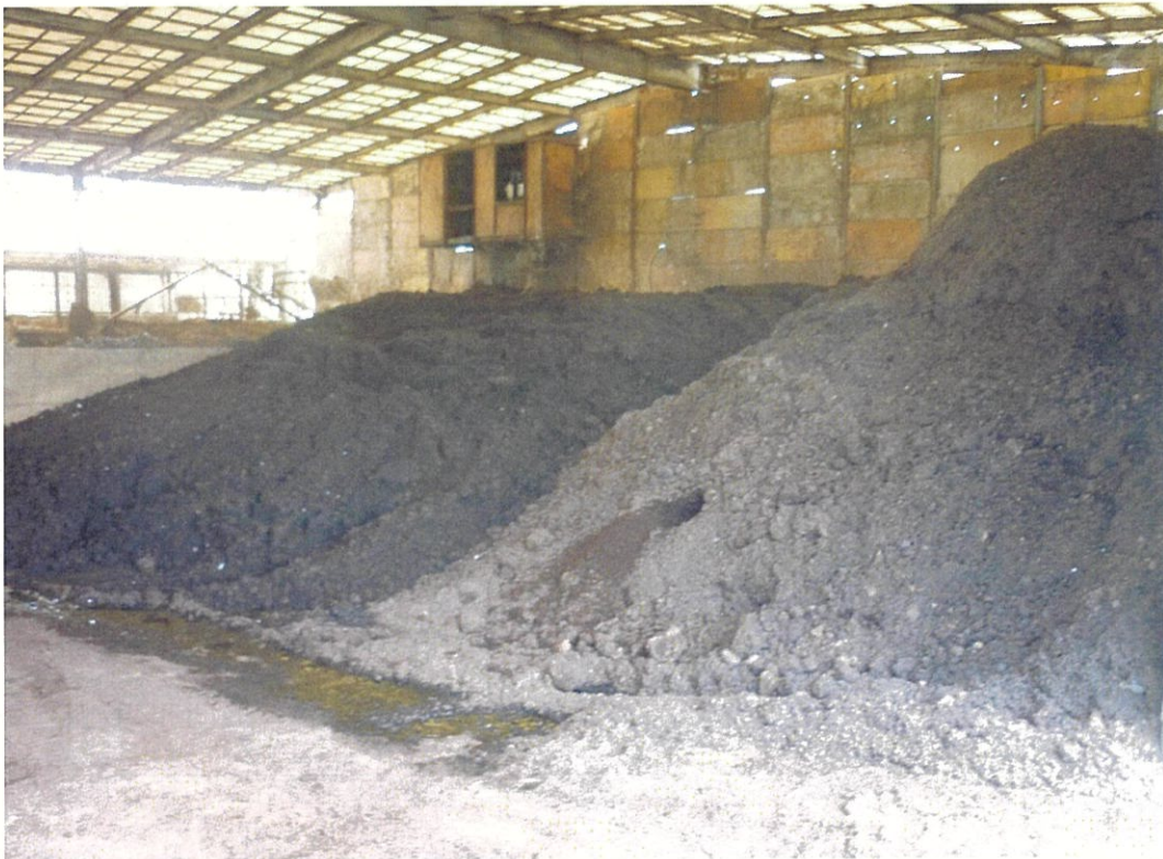
写真 10 水分・比重調整された堆肥化対象物(左奥の堆積山)
