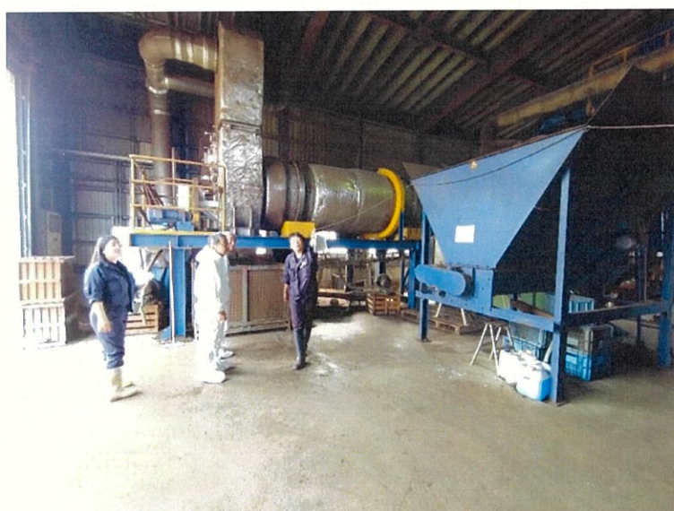
写真9 ロータリーキルンによる乾燥作業
