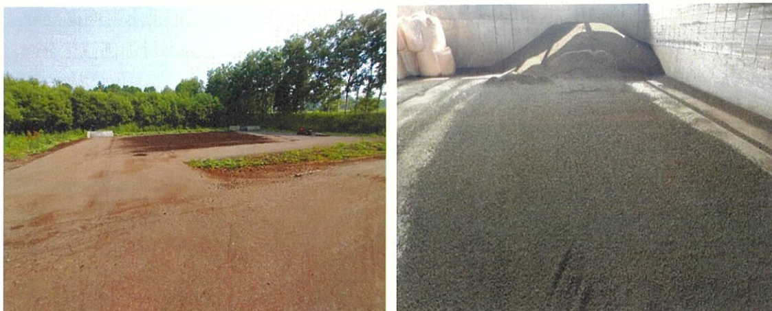
写真8 天日乾燥の状態(左)と屋内でも薄く広げて乾燥(右)
