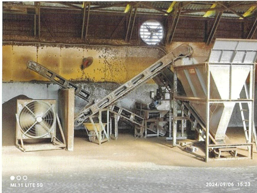
写真 5 堆肥造粒装置(全体)
