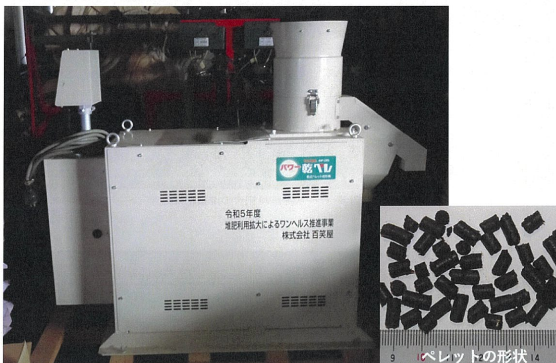
写真4 ペレット製造装置(タイワ精機 KNP-1501)とペレット堆肥
