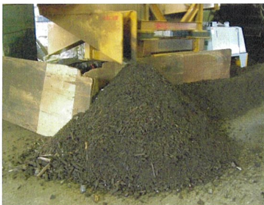
写真6 篩がけ装置(左)と分離された木片類(右)
