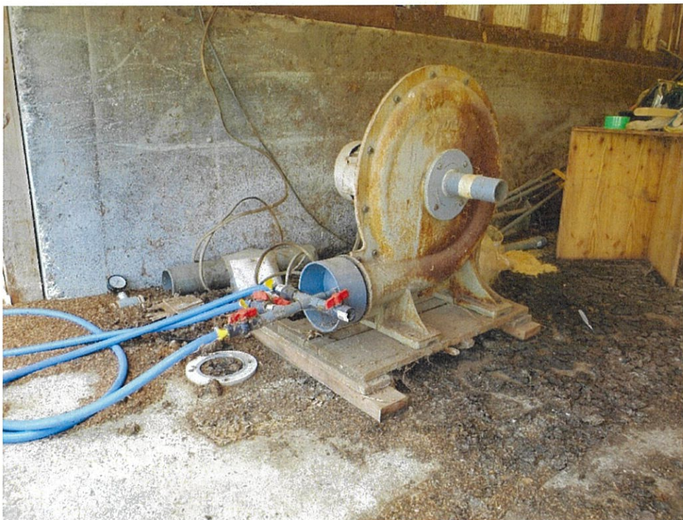
写真 11 下部通気専用ブロワ
