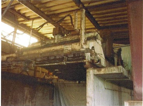
写真2 攪拌機(スクープを上昇待機状態)
