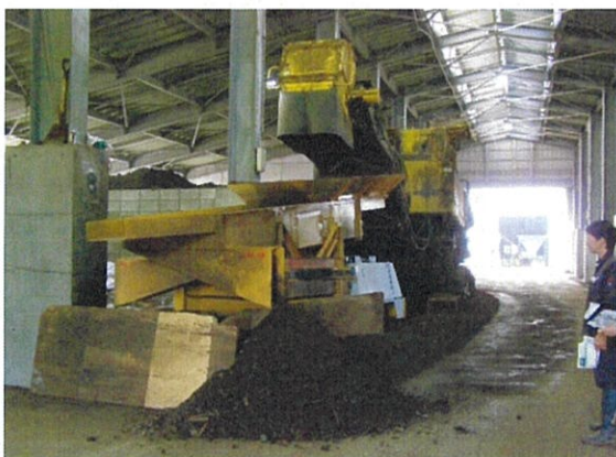
写真6 篩がけ装置(左)と分離された木片類(右)
